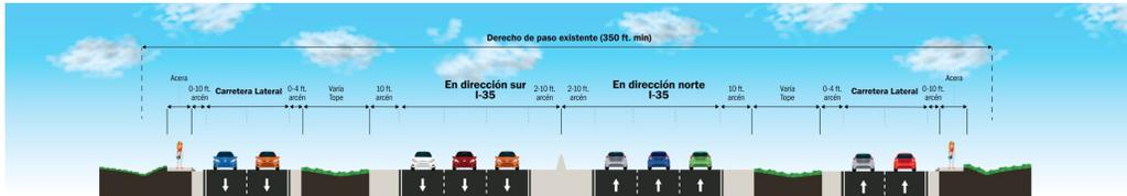
La configuración de la calzada y la anchura del derecho de paso varían a lo largo de la I-35. Aunque la figura de arriba ilustra la configuración general de la calzada, algunas secciones tienen carriles adicionales y no tienen arcenes ni aceras.
